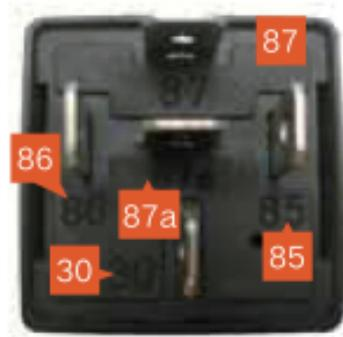
继电器接线示意图（注：4脚继电器没有87脚）
